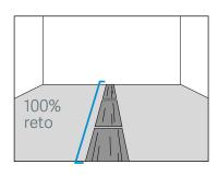
Cole a primeira parte medida e marcada de acordo com as instruções do fornecedor. Implemente tempos de abertura e de processamento corretos. Coloque os painéis mFLOR Dryback exatamente ao longo da linha de partida 100% reta.
