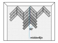
**5.** Cubra o piso com cola da largura de duas faixas e coloque as duas faixas sobre a cola. Ao fazê-lo, siga cuidadosamente as instruções do fabricante da cola relativamente ao tempo de abertura e tempo de aplicação.
