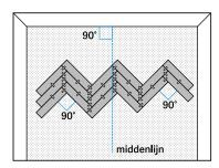
2. Coloque duas ou três filas de faixas uma contra a outra. Certifique-se que os cantos estão absolutamente a 90° e prenda bem as faixas com fita adesiva.
