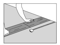
**3.** Meça cuidadosamente o último painel da primeira fila, colocando-o sem tensão contra a parede ou o plinto.
