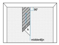
**3.** Coloque a peça de auxílio A com ângulos de 45° ao longo da linha central, certificando-se de que a peça de auxílio A não se encontra sobre a cola. Depois coloque a primeira fila de faixas sobre a cola. Comece com a faixa inicial e depois instale primeiro as faixas acima da faixa inicial.
