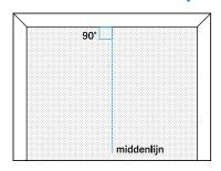
Determine o centro do espaço (como visto da parede inicial) e faça uma linha perpendicular à parede inicial com a ajuda de um fio-nível. Esta é a linha central.
